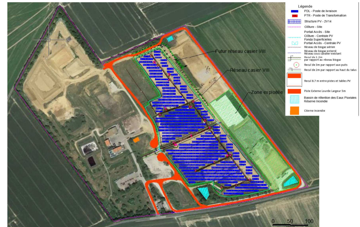
Illustration n° 5 : Projet d'implantation du parc photovoltaïque (Source : plan de masse du site, Acteam ENR, décembre 2021)
